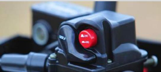
**ALLRADSCHALTER** - einfach drücken und der 4x4 schaltet sich zu. Die Differentialsperre wird ähnlich einfach per Kipphebel zugeschaltet, dazu muss das ATV stehen.
