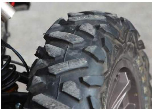
**Der *ABRIEB* auf den Reifen bei den Vorserien Testmodellen ist deutlich zu sehen. Runde 6.000 km hat dieser Vorderreifen 'runter'. Gelaufen ist er hauptsächlich bei Vollgas und durch unzählige Kurven in den umgebenden Bergen des Importeurs auf einer Höhe von bis zu 2.000 Meter über Null.**
