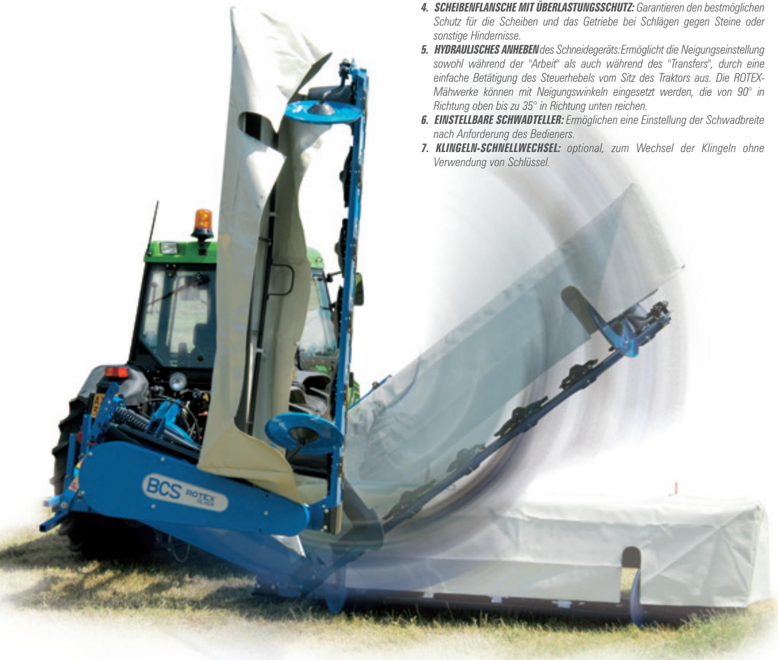
4. **SCHEIBENFLANSCH MIT ÜBERLASTUNGSSCHUTZ:** Garantieren den bestmöglichen Schutz für die Scheiben und das Getriebe bei Schlägen gegen Steine oder sonstige Hindernisse.
