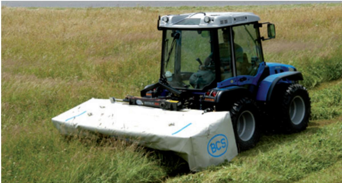
1. **DER RAHMEN DER ROTEX AVANT** besitzt eine gerade, kompakte, leichte und gleichzeitig widerstandsfähige Struktur. Hierdurch wird gewährleistet, dass die Maschinen auf optimale Weise bei allen Traktorarten eingesetzt werden können. Die Ausladung des Frontmähwerkes wurde bewusst möglichst gering gehalten, um die Lastverteilung am Traktor zu verbessern, Mähkombinationen möglichst wendig zu halten und die Stabilität vor allem für Mäh- und Bergtraktoren zu unterstützen.
