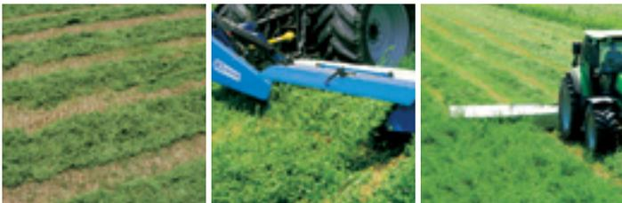
Die Heckanbau-Scheibenmäherwerke sind die Basis der **ROTEX** Produktlinie. Sie stehen in den Versionen zur Verfügung **Silver 4, Silver 5, Silver 6** und **TSB 5, TSB 6** und **TSB 7** und unterscheiden sich durch die Merkmalen des Tragrahmens und des Rahmens. Der Rahmen der Serie Silver ist fix, während bei den Serien TSB ist dieser in der Breite verstellbar zu einer besseren Anpassung an den Traktoren hoher Leistung.
